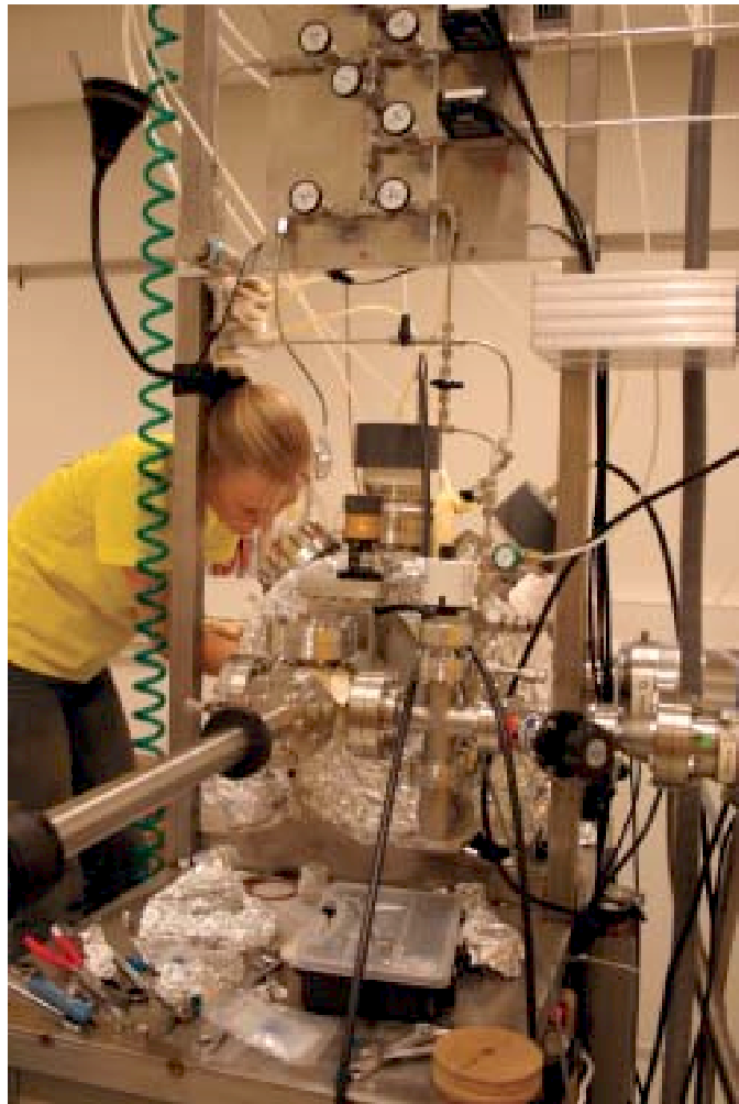
Mynd 4 Segulspæta sem notuð er til ræktunar þunnra húða. Þrjú skotmörk eru á segulspættunni sem gerir það kleift að rækta melmi úr þremur mismunandi frumefnum. Einnig má spæta til skiptis af skotmörkunum þremur og mynda yfirgrindur þar sem skiptast á lög mismunandi efna. Ljósmynd: Árni Sigurður Ingason.
