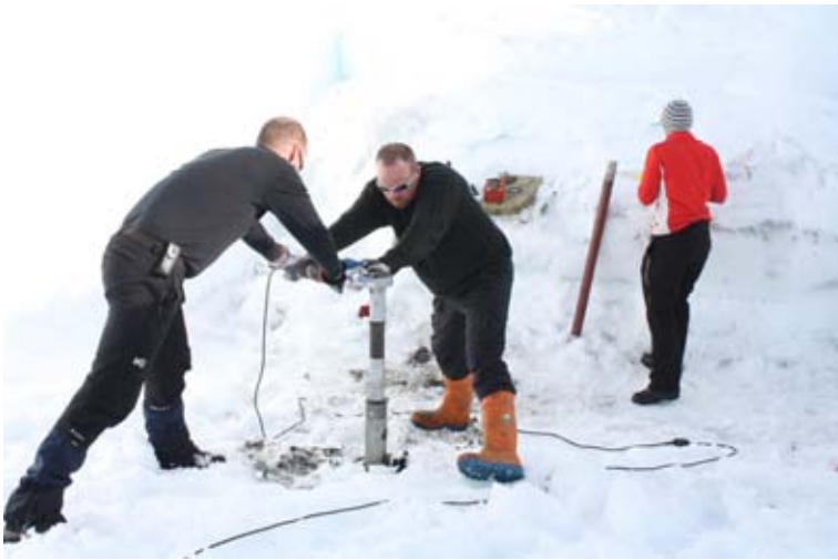
Borað niður í gjóskulagið frá 2004 í vesturhluta Grímsvatna. Á myndinni eru Einar Ragnar Sigurðsson, Hlynur Skagfjörð Pálsson og Tanya Jude-Eton. – A snow corer used to extract samples from the tephra layer from the 2004 eruption in Grímsvötn.
